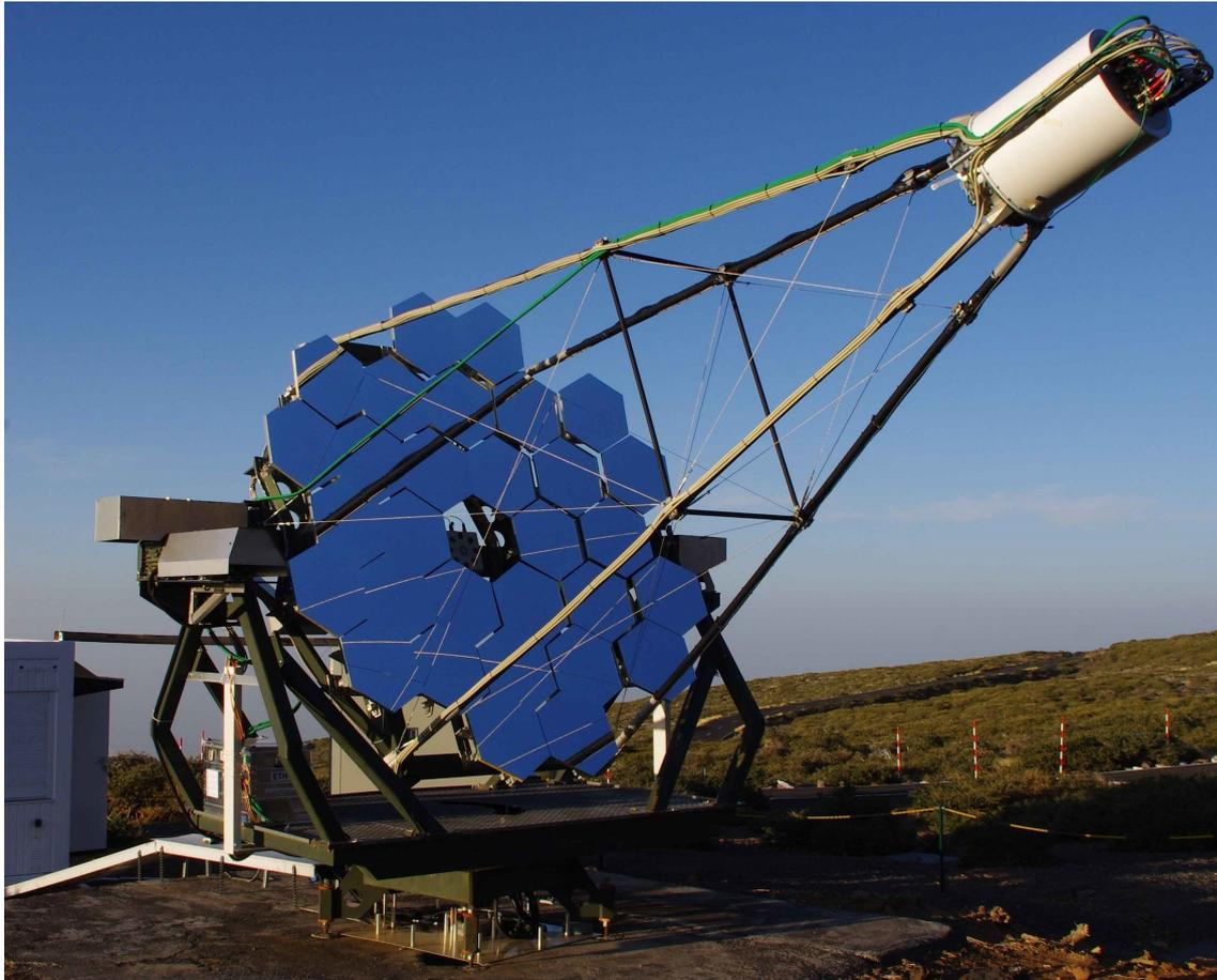
**Abbildung 5.2:** Das FACT Teleskop auf Gran Canaria [1]. Die Teleskopdaten entstehen durch die Aufnahmen einer Kamera (rechts oben), die auf eine Spiegelfläche gerichtet ist.
